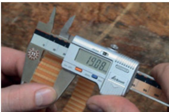
Gerade bei Verwendung von Führungsprofilen bedarf es einer genauen Abstimmung der Breitentoleranz von Riemen und Nut im Profil, um bei Erwärmung oder Verschmutzung der Antriebe Zwangslagen zu vermeiden.
