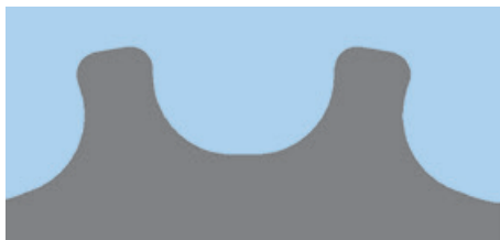
Halbrunde, parabolförmige Profile
