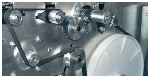
Druckerantrieb mit Zahnscheiben aus AL und Kunststoff PA6 GF
