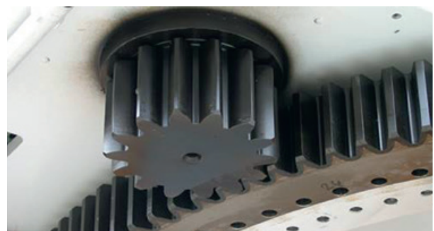
Modulverzahnung für Drehtischantrieb mit gehärtetem Zahnkranz
