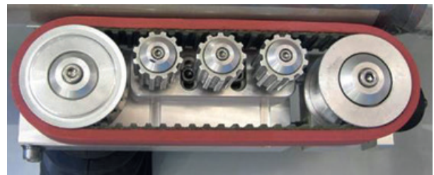
Zahnscheiben aus hochfestem Al für Schlauchbeutelmaschinen
